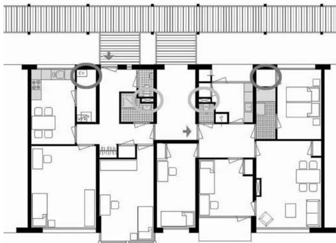
Figuur 10: behoud huidige leidingkokers en plaatsing nieuwe in voormalige balkonberging (links een gerenoveerde woning, rechts de huidige situatie)
